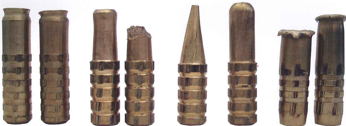
Erilaisia messinkiluoteja osuman jälkeen. Vasemmalla Woodleigh Hydro 790 m/s ja 849 m/s, Impala CHP Moose Stopper 878 m/s ja 1020 m/s, Impala LWHV 910 m/s, Impala RNFP 801 m/s ja Tarvas 844 m/s ja 770 m/s.
