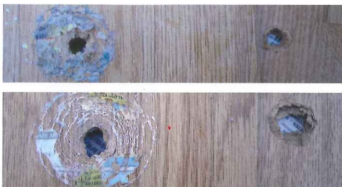
Tarvaksen ja Barnesin sisäänmeno (vas) ja ulostulo (oik) keinoaluissa. Sakaroitaan menettäneen Barnesin laajempi kärkiosa rikkoo enemmän luuta kuin siistimmin läpi porautuva Tarvas, mikä myös käytännössä vaikuttaa liihahävikkiin. Sisäänmenopuolelta "luun" pinnasta on myös hyvin nähtävissä haavakanavan koko.
