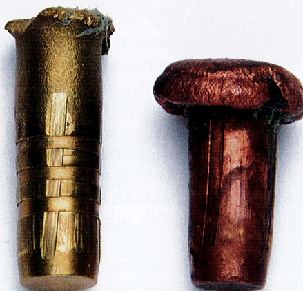
Vasemalla trumpetisoitunut Tarvas ja oikealla Lapuan Naturalis, joka on sienettynyt voimakkaasti. Valmistajan mukaan Tarvaksen kapeampi, mutta pidempi haavakanava aiheuttaa vähemmän lihahävikkiä kuin perinteisesti sienettyjen luotien laajempi haavakanava. Asia on tutkimisen arvoinen, mutta tärkeintä on kummankin luodin erinomainen tappoteho vaikeissakin osumissa.
