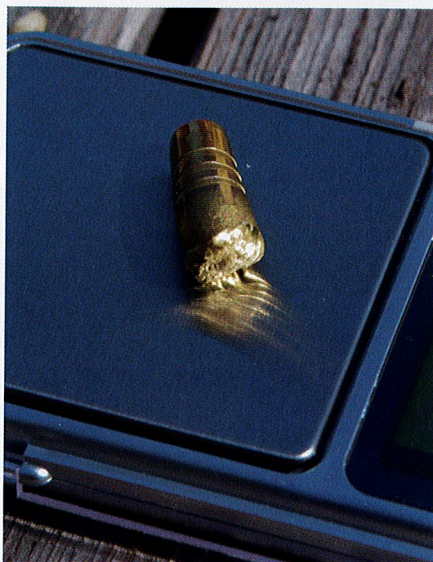
Perinteinen lyijysydäminen luoti hajosi luuosumassa pieniksi partikkeleiksi.
