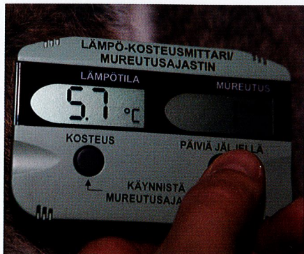
Ajastimen oikeaa nappia painamalla näkee jäljellä olevien riiputuspäivien määrän olettaen, että lämpötila pysyy samana. Vasemmalla napilla voi tarkastaa ilman kosteusprosentin.
